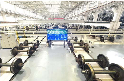
苏家屯车辆段数智化轮轴检修线。
