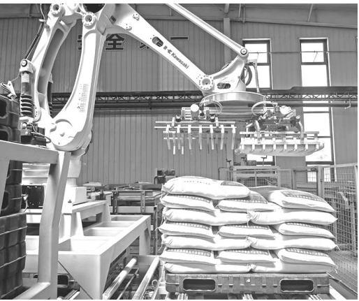
近日,陕西龙富绿源食品开发有限公司里,智能机器人在码垛面粉。 家坡镇等重点区域,建成47.46万亩小麦专供基地,实现专用小麦规模化、标准化、集约化种植。同时,创新推行“专种、专收、专储、专用”产业模式,在凤鸣镇食品工业园建成10座大型自动化小麦立式储粮钢板仓,有效实现优质原粮科学储备、稳定供给、保质保鲜。 从优质原粮到精品面粉,从田间地头到生产车
