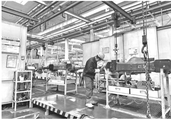
陕西汉德车桥有限公司工人在进行焊接。 付玉玮 摄
