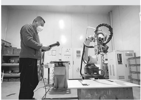
近日,陕西惠齐电力科技开发有限公司车间内,工作人员正在操作激光切割机机器人进行电力设备部件加工。该企业依托智能化生产技术,不断提升电力装备制造水平,为咸阳制造业发展和产业结构优化提供有力支撑。 周季 摄
